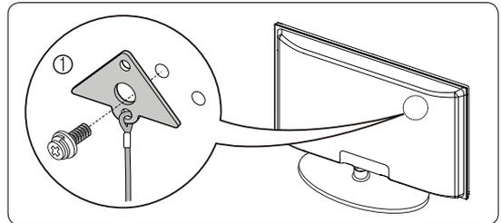
2. Vissez fermement la vis que vous avez fournie (taille M4xL20 ou similaire) à l'armoire ou au mur sur lequel le téléviseur doit être installé.
