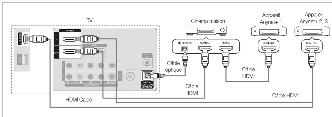
1. Raccordez la prise **HDMI IN (1 (DVI), 2 ou 3)** du téléviseur à la prise de sortie **HDMI OUT** de l'appareil Anynet+ correspondant à l'aide du câble HDMI.
