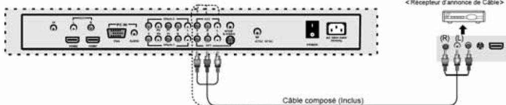
Raccorder le composant de sortie du téléviseur LCD au composant de sortie OUT (Sortie) de récepteur de diffusion par câble en utilisant le câble composé inclus (s'assurer que la couleur de la borne et la couleur de câble sont pareilles).
