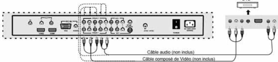
1. Raccorder la borne de YPbPr1 ou YPbPr2 du téléviseur LCD à la borne de Sortie vidéo de DVD.
