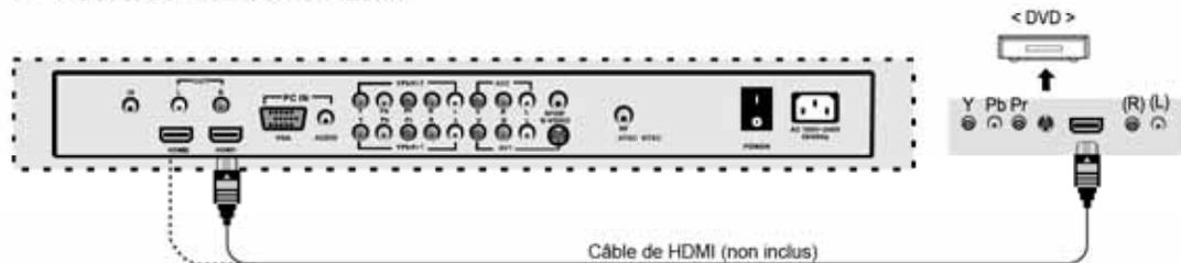
Raccordement à partir de la borne HDMI à la borne HDMI.
