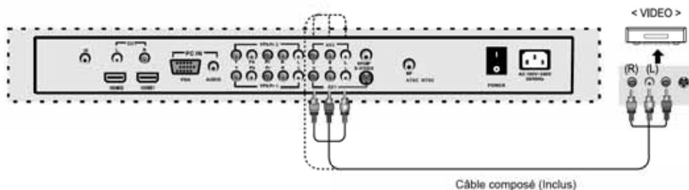
Connecter la borne In composite du téléviseur LCD à la borne Out en utilisant le câble composé inclus (s'assurer que la couleur des terminaux et la couleur du câble sont les mêmes)
