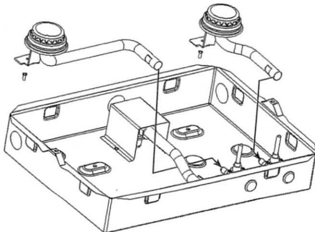
**Les sorties de vannes doivent être installés solidement dans les tuyaux des brûleurs avant d'installer la table de cuisson à nouveau. Non-respects de ces consignes peuvent provoquer un incendie ou une explosion et causer des blessures corporelles, des dégâts matériels ou la mort.**
